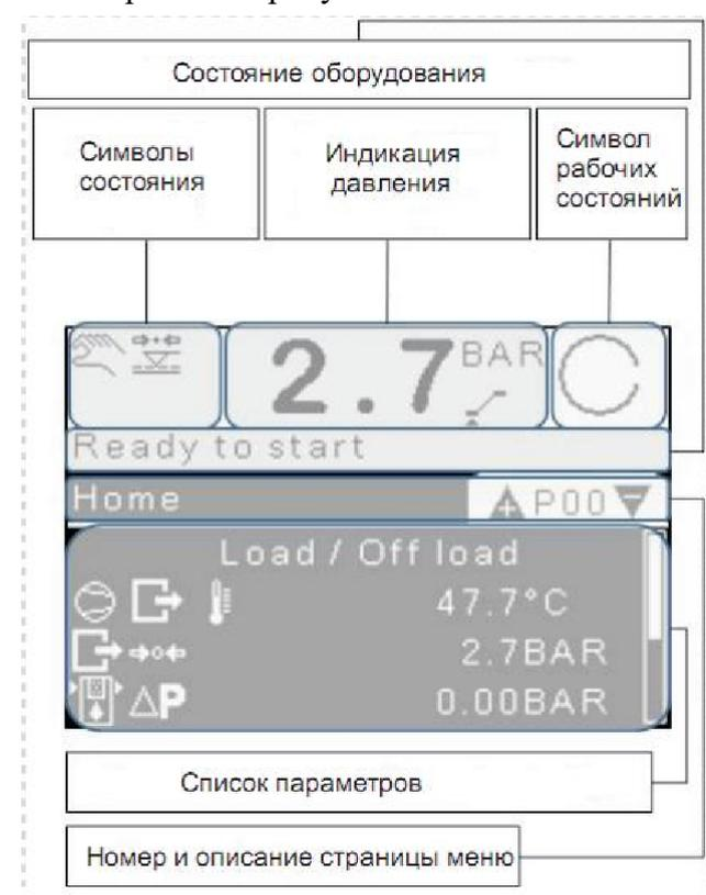
Рис. 1. Дисплей контроллера
