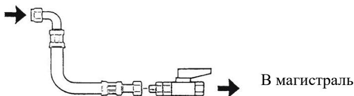
Между установкой и потребителем сжатого воздуха необходимо наличие воздухоборника емкостью ( $\text{м}^3$ ) не менее 30% от ее производительности ( $\text{м}^3/\text{мин}$ ). Пневмосеть считается частью данного воздухоборника.
