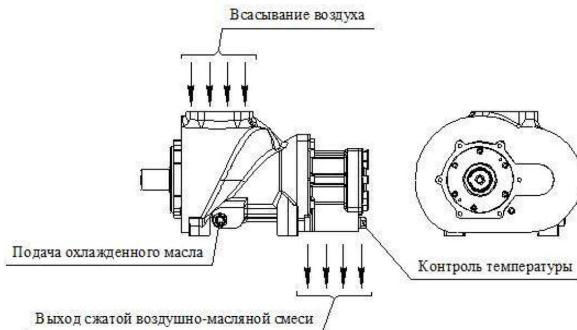
**ВНИМАНИЕ:** НАПРАВЛЕНИЕ ВРАЩЕНИЯ ВАЛА ВИНТОВОЙ ГРУППЫ УКАЗЫВАЕТ СТРЕЛКА, РАСПОЛОЖЕННАЯ НА ВИНТОВОМ БЛОКЕ СО СТОРОНЫ ТОРЦА ВАЛА.
