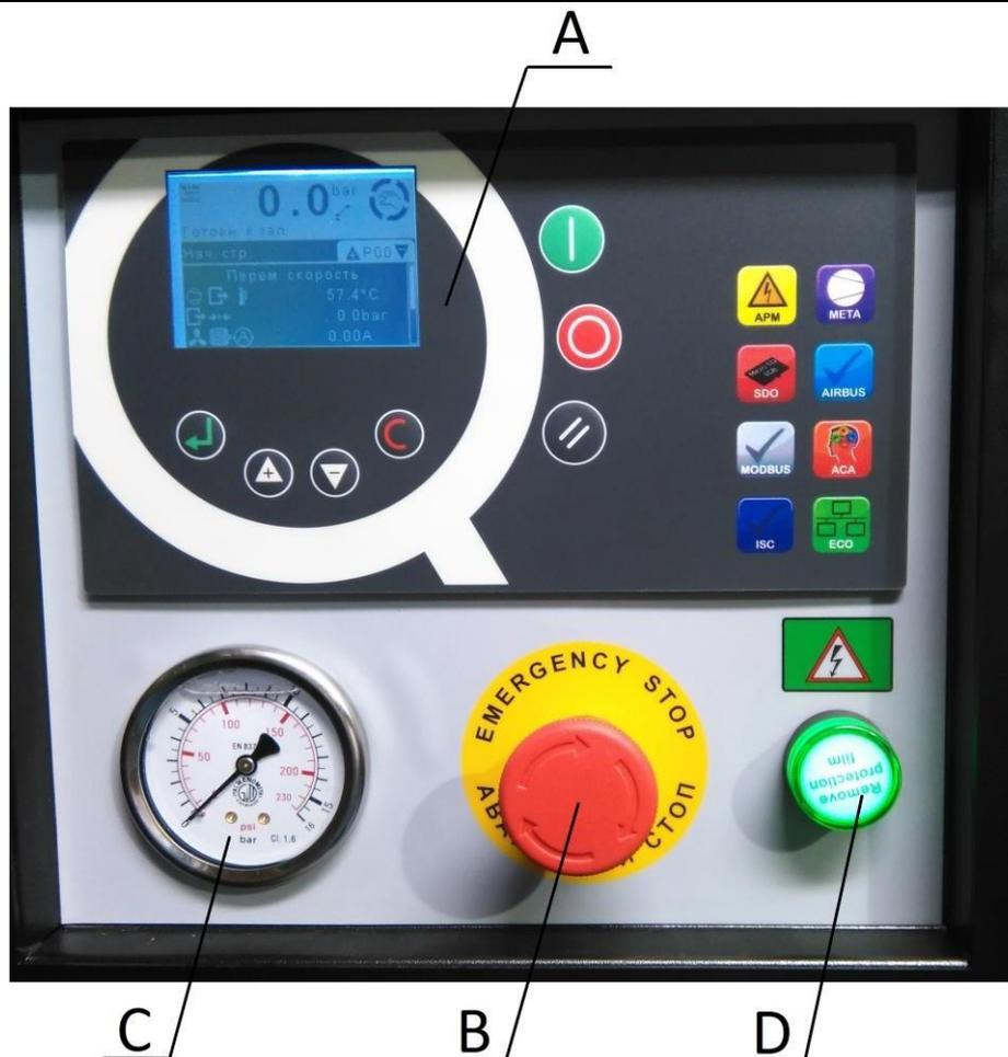
**А** - электронный контроллер предназначен для управления и контроля работы компрессорной установки (см. руководство пользователя контроллера).
